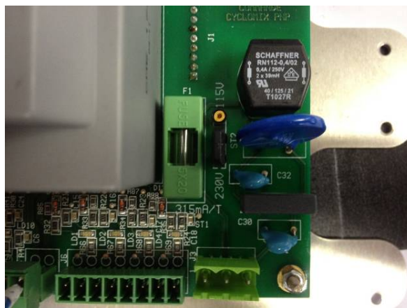
Fusible 315 Ma para CYCLOMIX™ MICRO cuyo número de serie es > a 09Y1080
