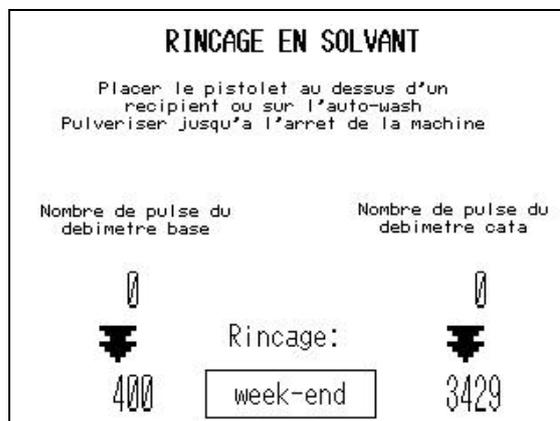
La machine effectue un rinçage PRODUCTION, puis rince le circuit CATALYSEUR : compteur, vannes automatiques, mélangeur, tuyau et pistolet avec du solvant catalyseur. Il est alors possible d'éteindre la machine ou de repartir en production avec n'importe quelle recette.
