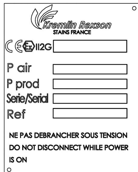
流体盘铭牌 (流体盘安装在喷房内 → 符合欧盟 ATEX 防爆安全法令)
