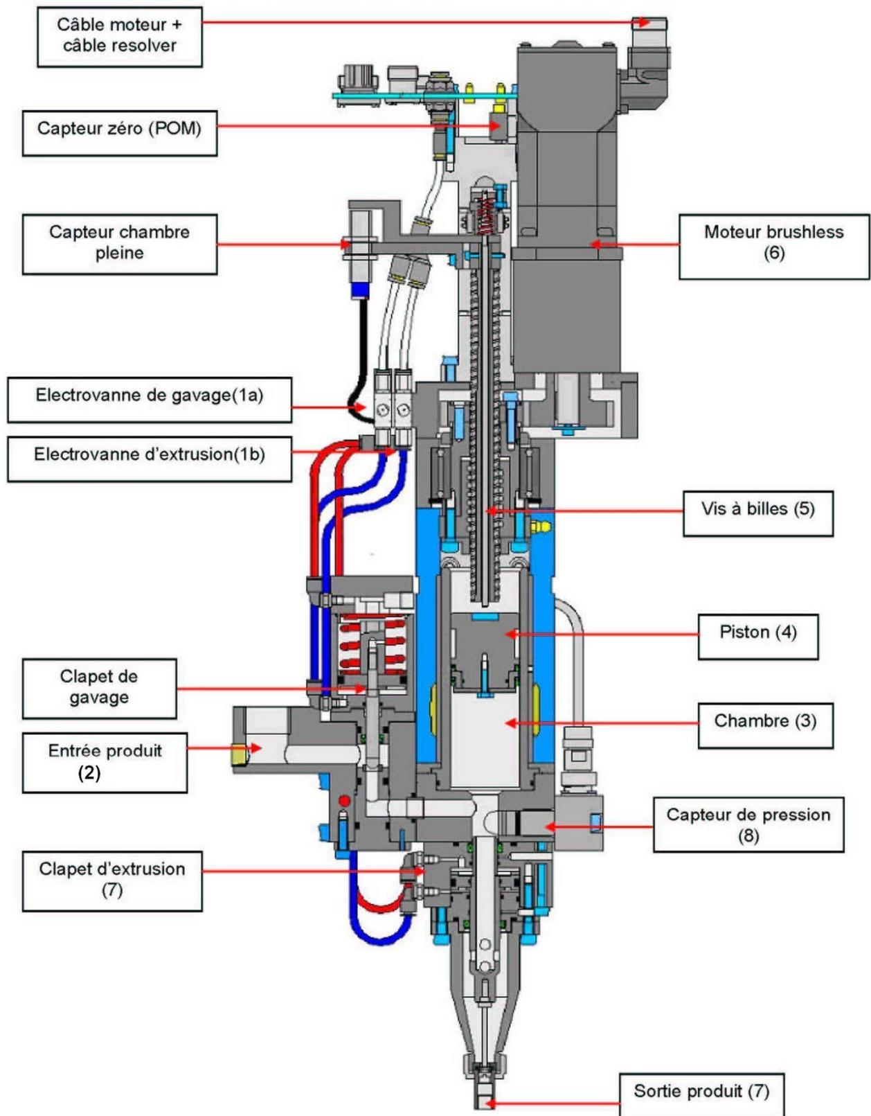
Le système de dépose se compose de 3 actionneurs :
