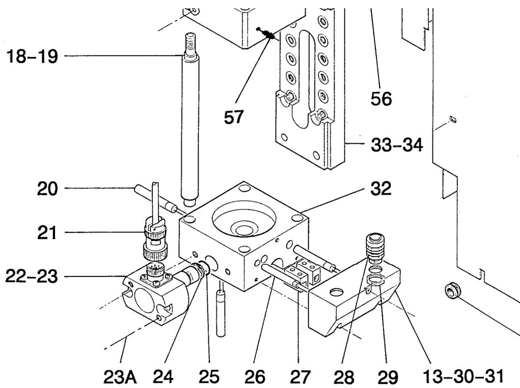
Démonter la vanne d'entrée et la vanne de sortie du doseur.
