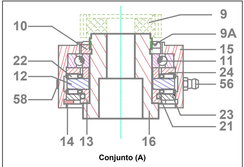
Cambiar el conjunto (A). Volver a montar el piñón receptor (9), los pasadores (8), la arandela (28) y los 2 tornillos (29).
