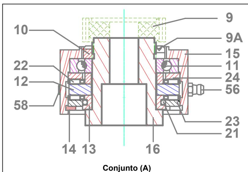
Cambiar el conjunto (A). Volver a montar el piñón receptor (9), los pasadores (8), la arandela (28) y los 2 tornillos (29).
