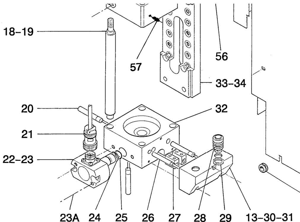
Desmontar la válvula de entrada y la válvula de salida del dosificador.
