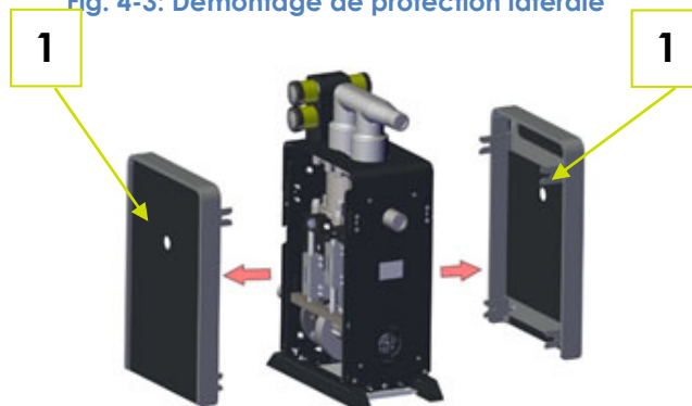
Fig. 4-3: Démontage de protection latérale
