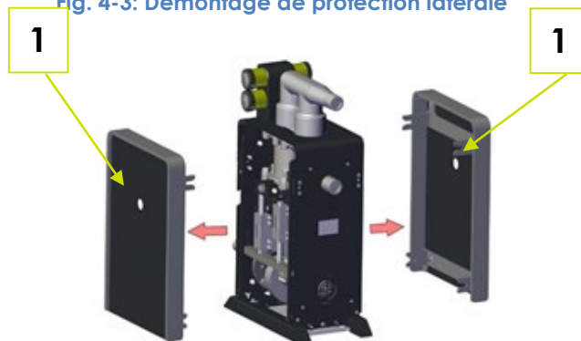
Fig. 4-3: Démontage de protection latérale
