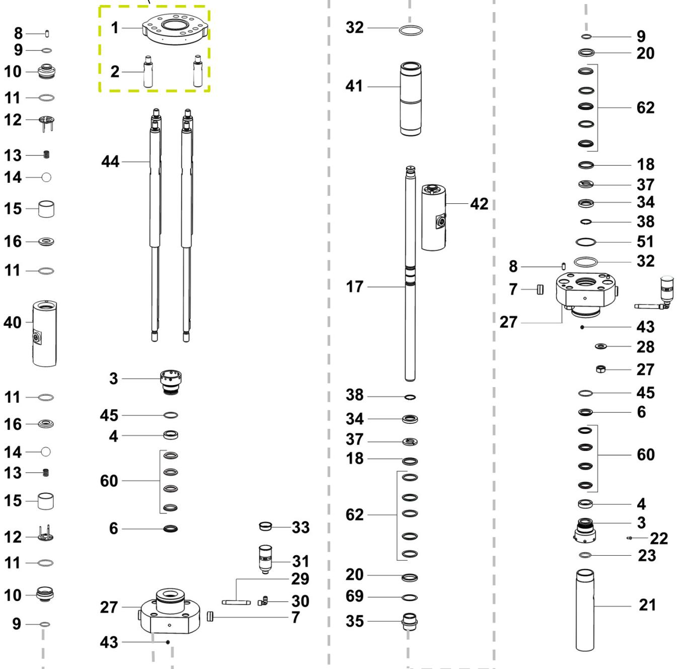
**Flüssigkeitskammer PEEK-Dichtungen Version**
