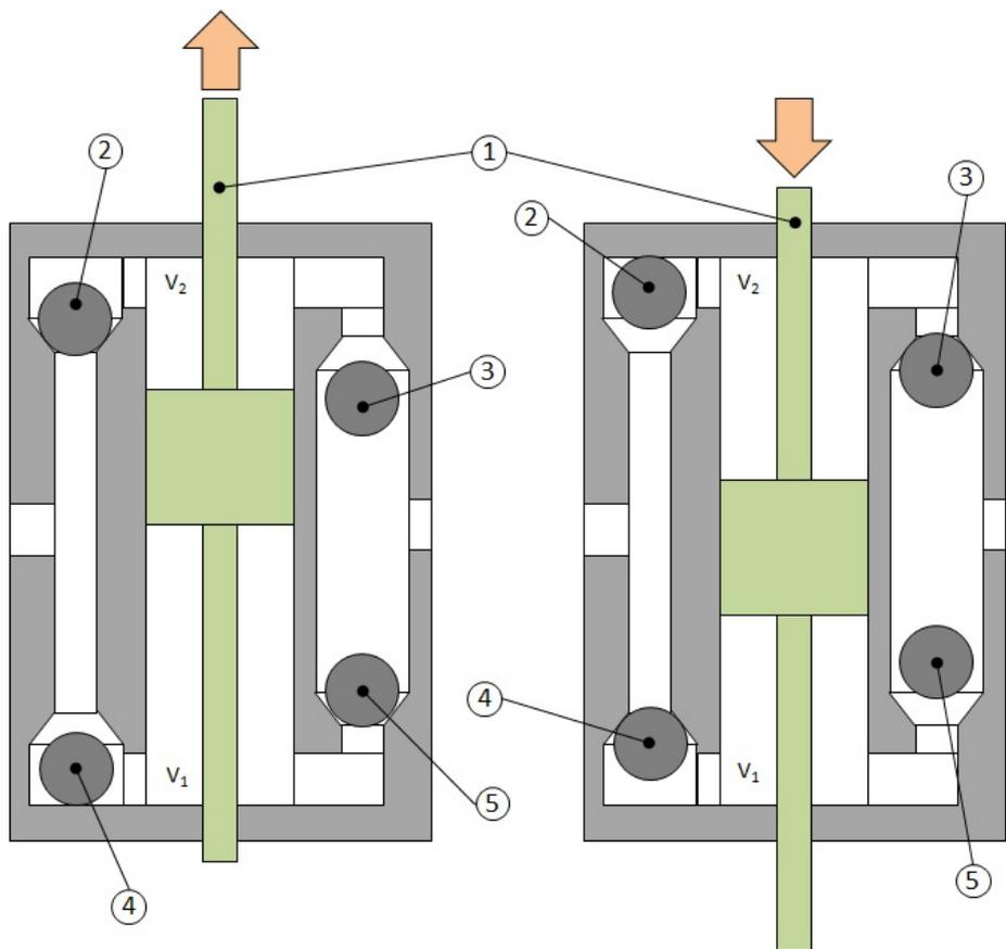
Wenn sich der Kolben (1) hebt, schließen sich die Rückschlagventile 2 und 5, während sich die Rückschlagventile 3 und 4 öffnen. Der Kolben (1) stößt das Material aus dem oberen Raum (V2) und saugt das Material an, um den unteren Raum (V1) zu füllen.
