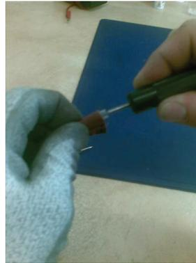
Engager l'embout en le vissant dans l'avant trou en maintenant le câble avec la toile à poncer.
