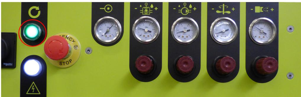
**Le premier appui** déclenche l'alimentation en air comprimé de la pompe, du régulateur (si présent) ainsi que la ventilation de l'armoire.
