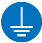
Pour éviter les risques dus à l'électricité statique, il est nécessaire que le matériel ainsi que ses constituants soient mis à la terre.
