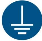
Bei der Verwendung mit einem Luftmotor muss die Hydraulik über das Erdungskabel dieses Motors geerdet sein.
