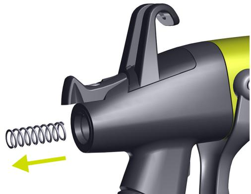
o utilizar la aguja de pintura para sacar la válvula de aire.
