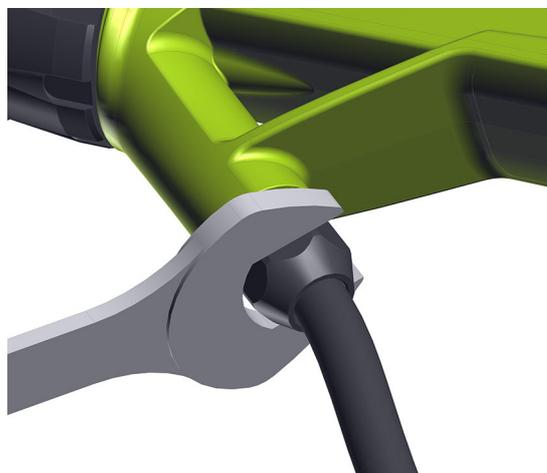
**Para volver a montarlo, atornille la tuerca superior del tubo de pintura, hasta el tope. Posicione la contra tuerca del prensaestopa debajo de la escuadra, y el prensaestopa superior en la huella hexagonal. Apriete la contra tuerca del prensaestopa sobre la escuadra.**
