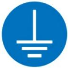
Pour éviter les risques dus à l'électricité statique, il est nécessaire que le matériel ainsi que ses constituants soient mis à la terre.
