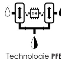
La technologie **Injectmix** permet d'injecter un volume de catalyseur personnalisé dans un flux continu de base directement dans un mélangeur haute performance, garantissant ainsi la qualité du mélange. Les deux produits sont ensuite instantanément mélangés dans un mélangeur statique en ligne sans chambre de pré-mélange intermédiaire.
