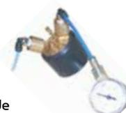
Les chapeaux permettent de mesurer la pression (bar) de la chambre d'air (air de corne et air de centre) au niveau de la tête du pistolet. Ces mesures sont très importantes pour définir la forme du jet (symétrie, largeur...).
