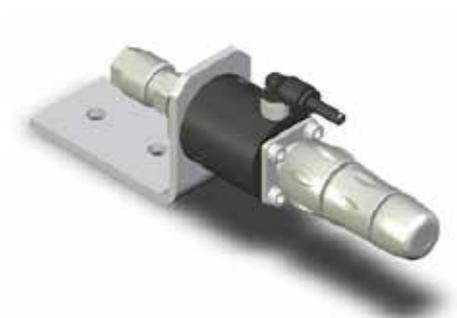
Le principe de lecture de la vitesse de rotation repose sur une mesure acoustique. L'air arrive au niveau du bol, il est guidé par une rainure et acheminé à chaque tour de la turbine, pour créer un changement de pression qui remonte jusqu'au capteur. Le signal est ensuite converti en variations électriques, permettant ainsi l'ajustement de la vitesse de rotation du bol.
