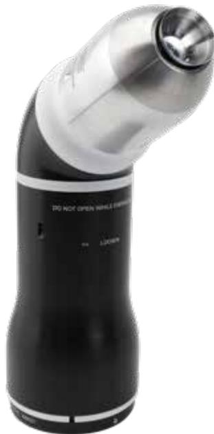
Pulvérisateur robotique de peinture à base solvantée muni d'un bol rotatif grande vitesse
