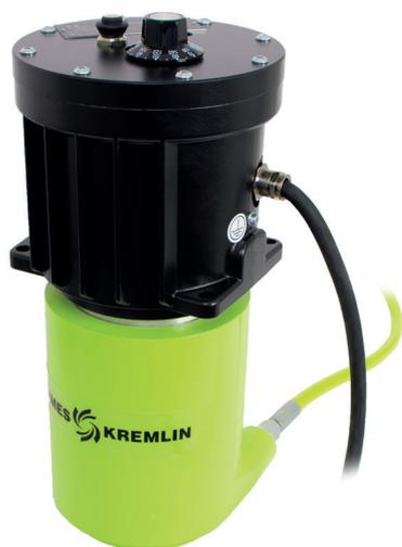
Le réchauffeur produit est un appareil auxiliaire utilisé pour la préparation des peintures et le chauffage de l'air. Il est possible d'augmenter l'épaisseur des couches déposées en chauffant le produit et obtenir des temps de séchage plus courts ainsi qu'une meilleure qualité de finition.
