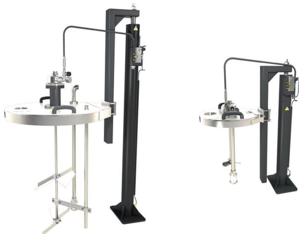
Cet agitateur-élévateur pour fûts de 20-40 à 200 litres est équipé d'un support double effet permettant de lever rapidement le couvercle en acier inoxydable pour un changement de fût rapide. Le couvercle est équipé d'un agitateur motorisé avec des lames pour produits à faible viscosité et d'une canne entièrement en acier inoxydable.
