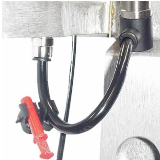
Alle werkseitig montierten Motoren sind mit einer **Standardsteuerung** verkabelt. Dies bedeutet, dass das Luftmotor-Umkehrsystem (genannt Pilot) an den gleichen Druck wie die Hauptmotorversorgung angeschlossen ist. In diesem Fall liegt die Anlaufschwelle des Motors bei etwa 1,5 bar / 21,7 psi.
