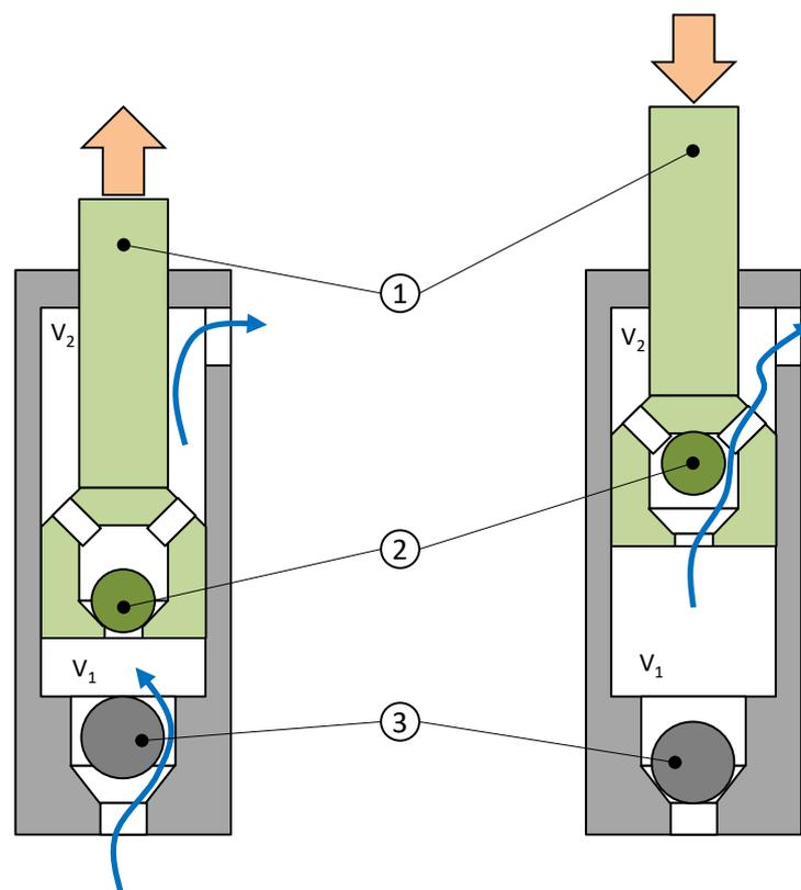
Wenn der Kolben (1) nach oben fährt, schließt sich die obere Klappe (2) und die untere Klappe (3) öffnet sich. Der Kolben (1) stößt das Material aus dem oberen Raum (V<sub>2</sub>) und saugt das Material an, um den unteren Raum (V<sub>1</sub>) zu füllen.
