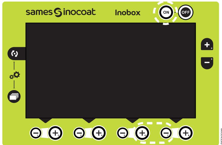
Ecran de veille: Par défaut, la mise en veille est effective au bout de 15 minutes d'inactivité, néanmoins l'opérateur peut modifier cette temporisation sur l'écran de paramétrage 4 ([voir § 7.1.5.7 page 49](#)). La sortie du mode veille peut être obtenue par un appui sur une touche du clavier à l'exception des touches ON /OFF ou sur la gâchette pistolet.
