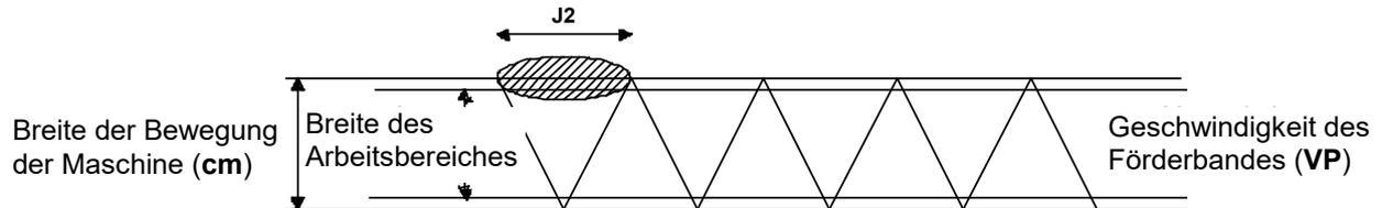
Diese Breite J2 für 2 gleichmäßige Lackschichten (1x Vorwärts- und 1x Rückwärtsbewegung) entspricht genau folgender Formel:
